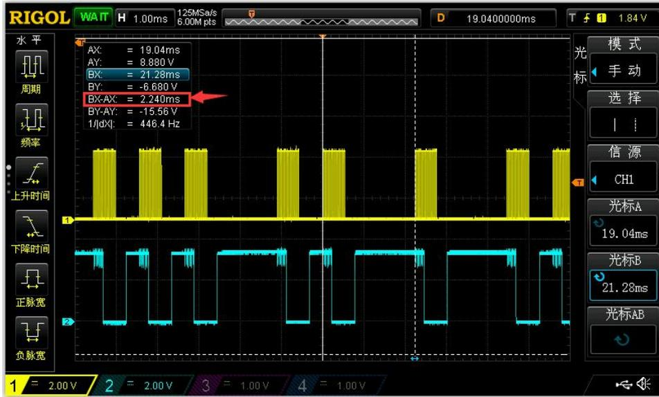
■ 4.1、NEC 协议码“1”的前部分：0.56ms 的载波发射
