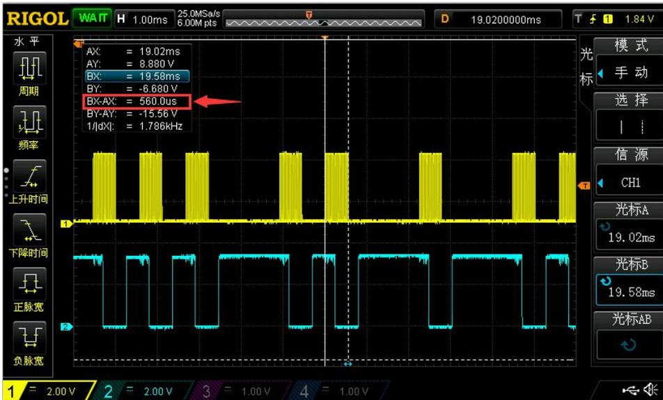
■ 4.2、NEC 协议码“0”的后部分：1.68ms 的载波不发射
