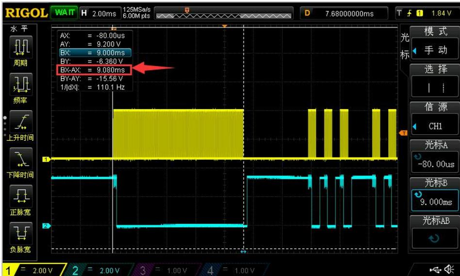
■ 5.2、NEC 引导码的后部分：4.5 的载波不发射
