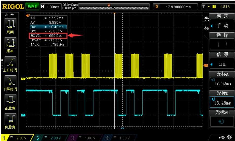
■ 3.2、NEC 协议码“0”的后部分：0.56ms 的载波不发射
