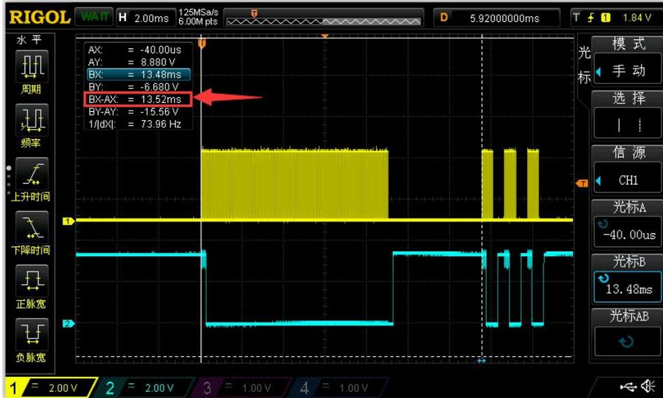
■ 5.1、NEC 引导码的前部分：9ms 的载波发射
