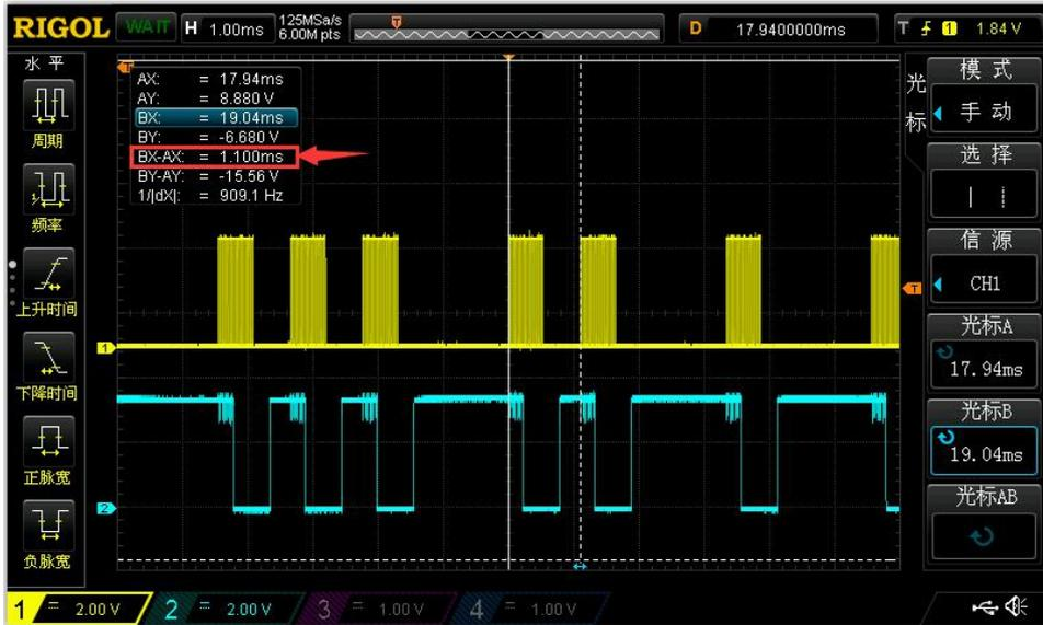
■ 3.1、NEC 协议码“0”的前部分：0.56ms 的载波发射
