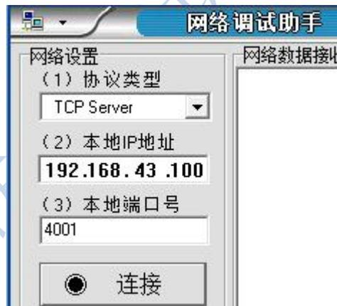
图 7.3.1.a TCP 服务器端参数设置
