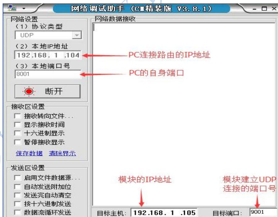
图 7.4.2.a PC 端 UDP 网络连接参数设置
