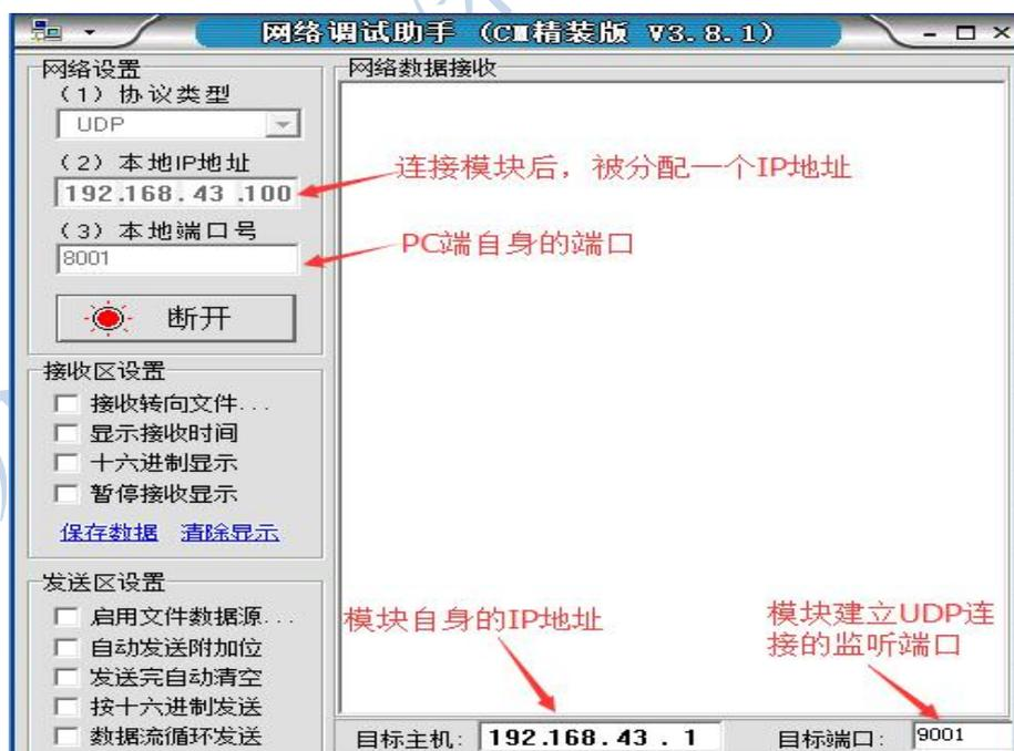
图 7.4.1.a PC 端 UDP 网络连接参数设置
