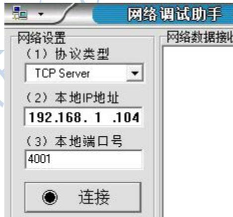
图 7.3.2.a TCP 服务器端参数设置
