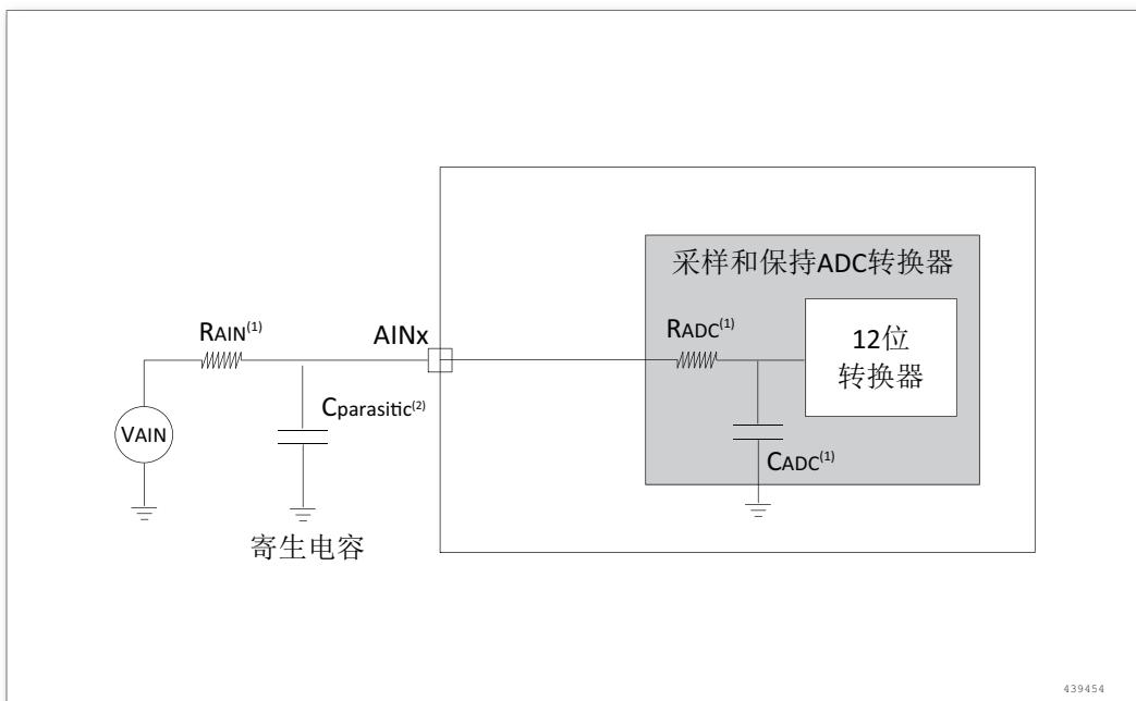
图 19. 使用 ADC 典型的连接图
