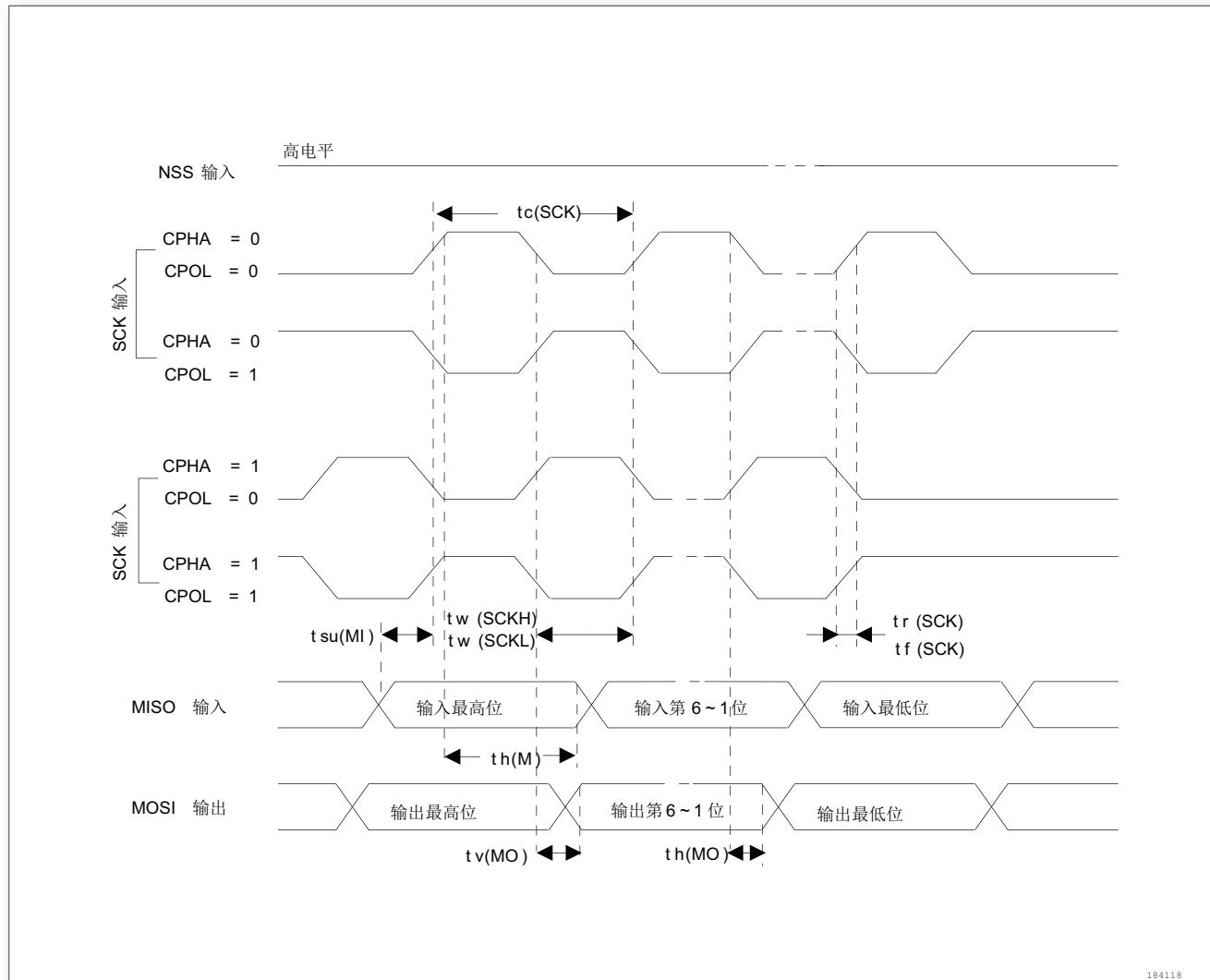
图 18. SPI 时序图-主模式<sup>(1)</sup>
