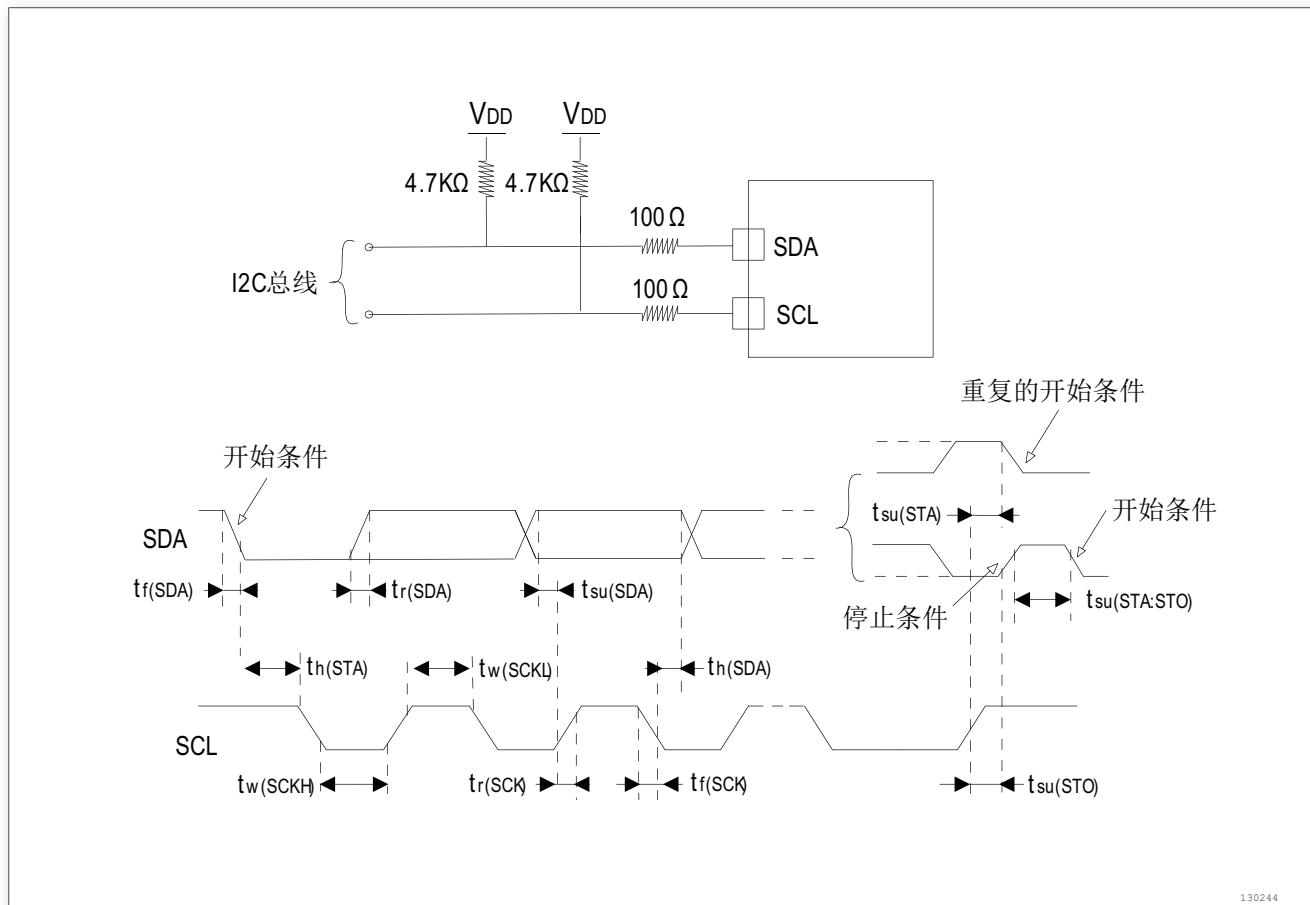
图 15. I2C 总线交流波形和测量电路<sup>(1)</sup>
