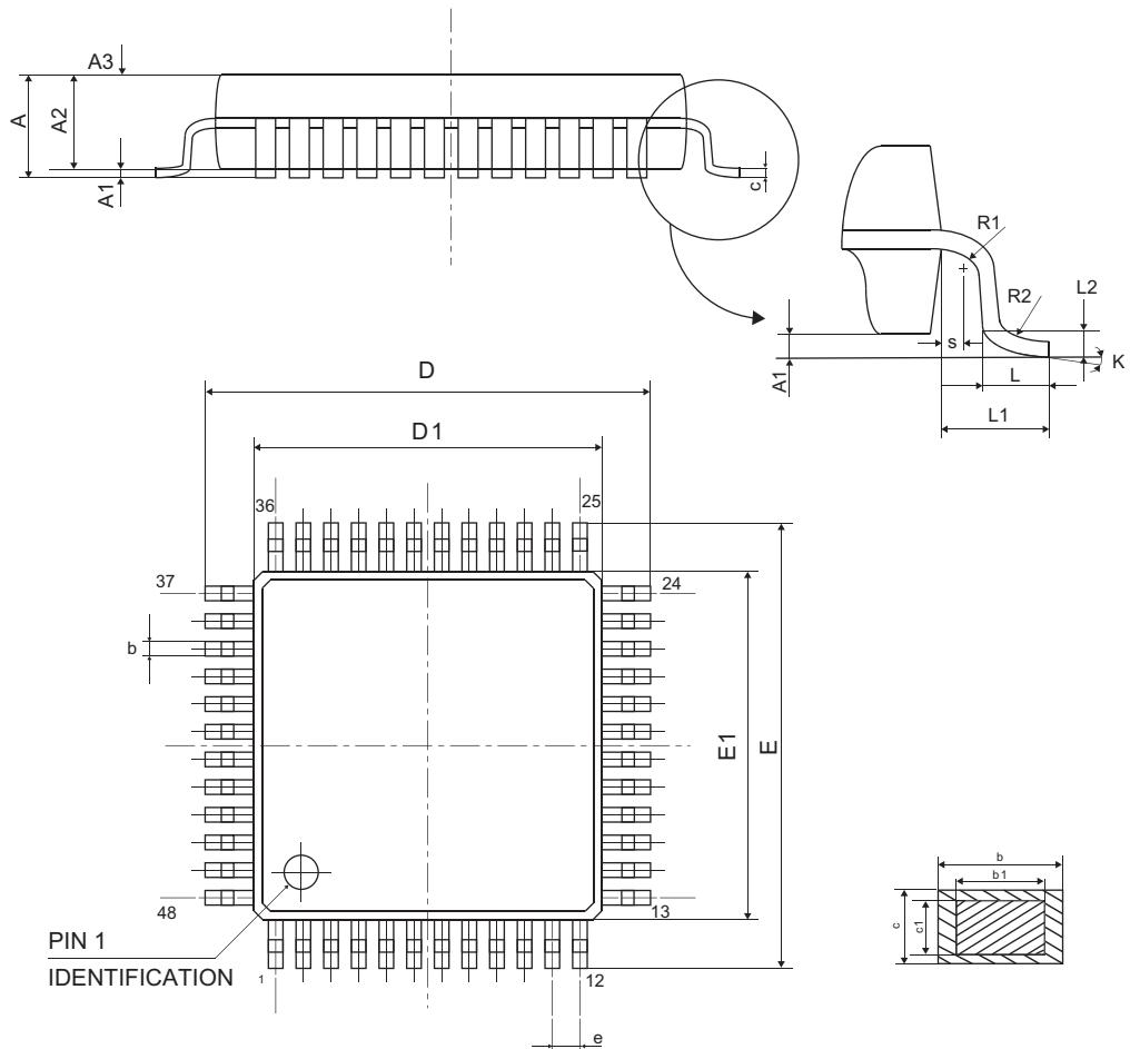
图 21. LQFP48, 48 脚低剖面方形扁平封装图
