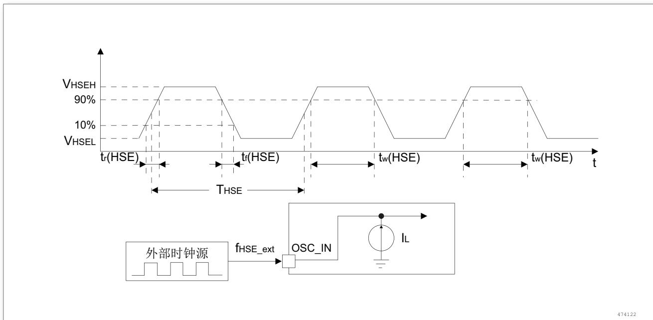
图 11. 外部高速时钟源的交流时序图
