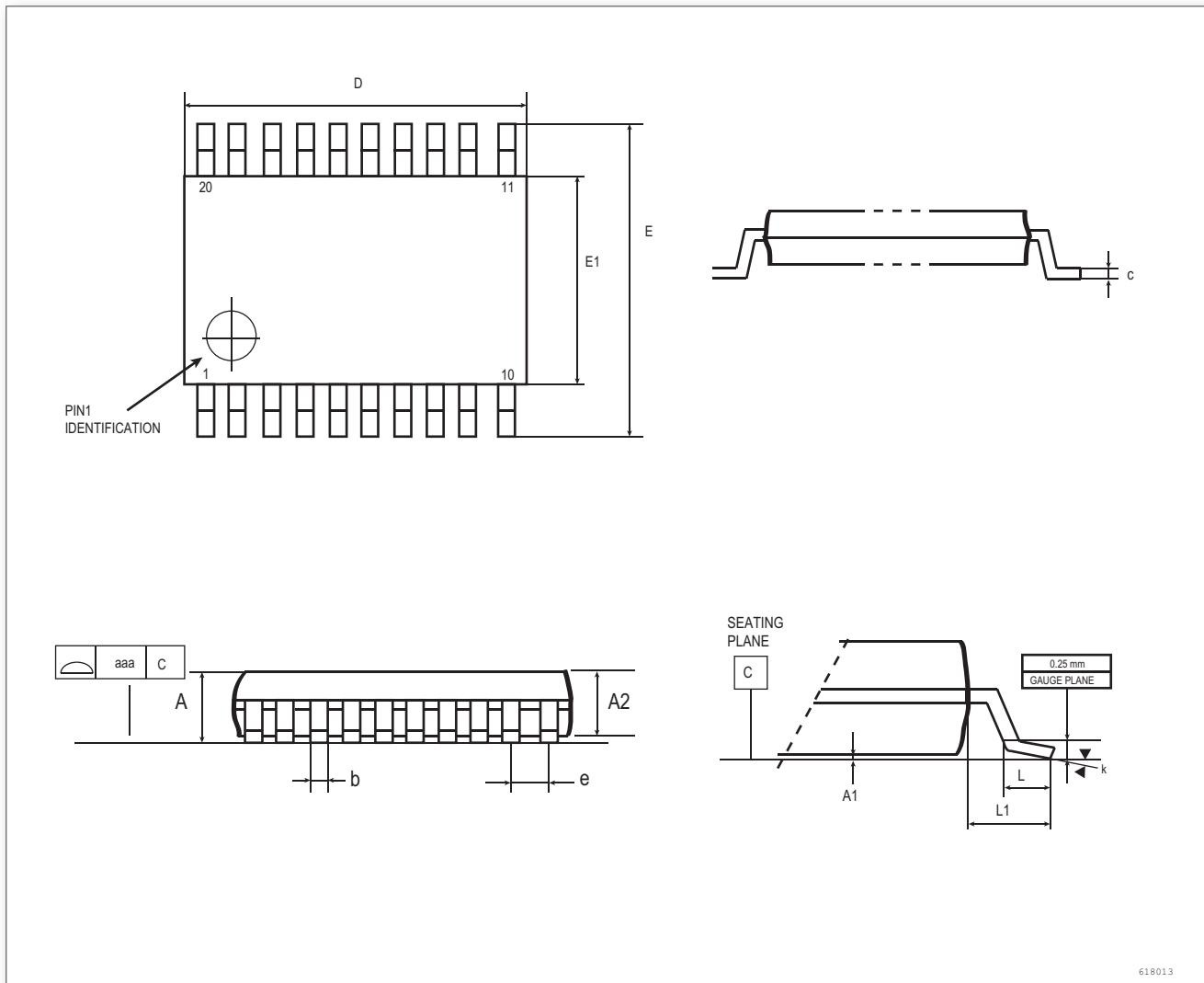
图 24. TSSOP20, 20 脚低剖面长方形扁平封装图
