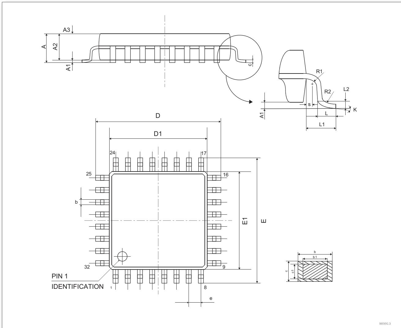
图 22. LQFP32, 32 脚低剖面方形扁平封装图
