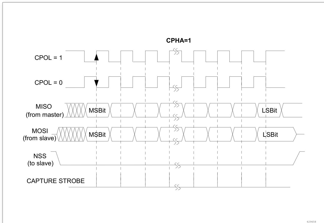
图 17. SPI 时序图-从模式和 CPHA = 1<sup>(1)</sup>
