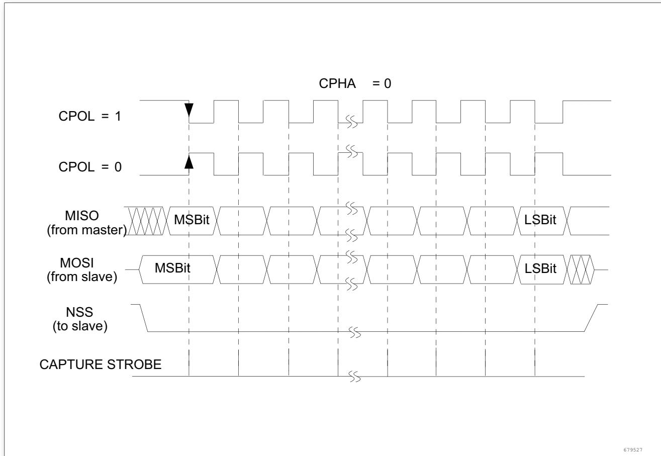
图 16. SPI 时序图-从模式和 CPHA = 0
