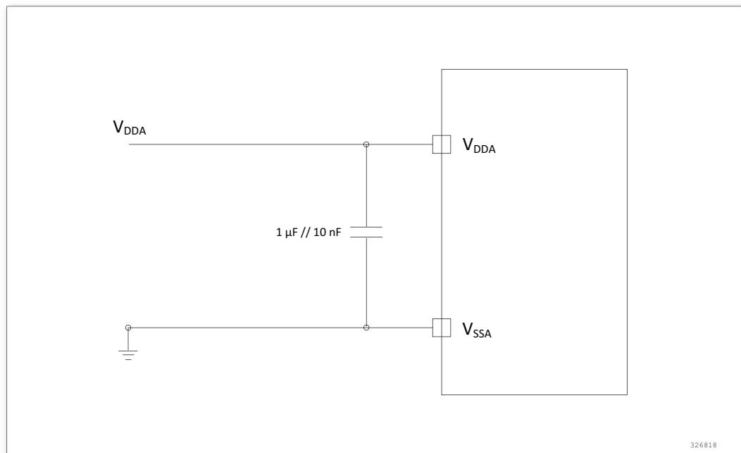
图 20. 供电电源和参考电源去藕线路
