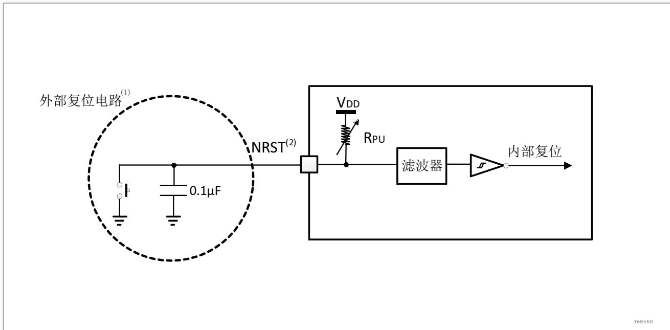
图 14. 建议的 NRST 引脚保护
