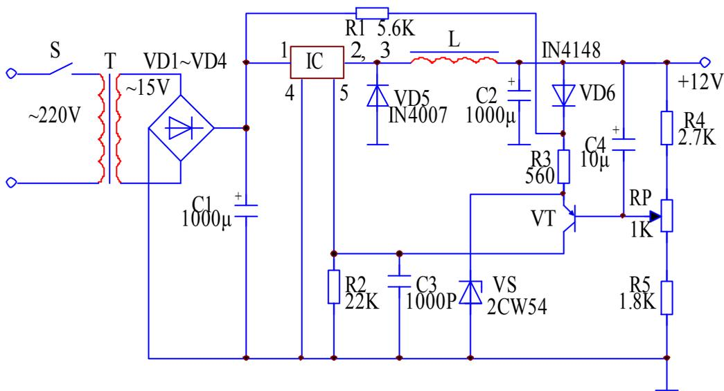
图 45 开关直流稳压电源电路图
