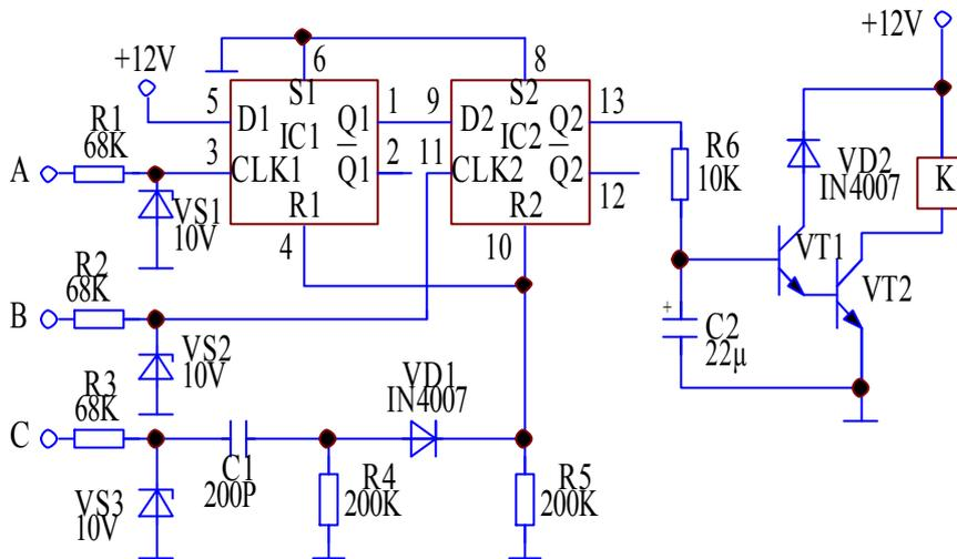
图 48 三相交流电相序检测器电路图
