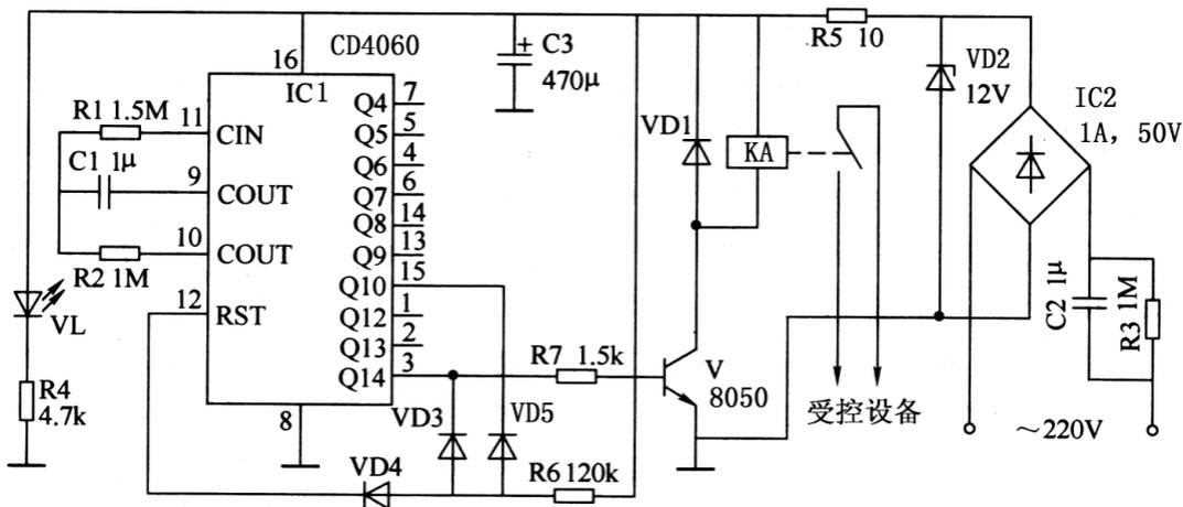
图 15 循环工作定时控制器电路原理图
