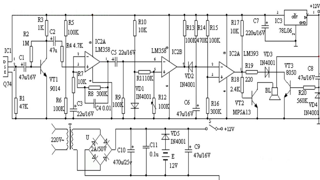
图4 红外线探测防盗报警器电路图
