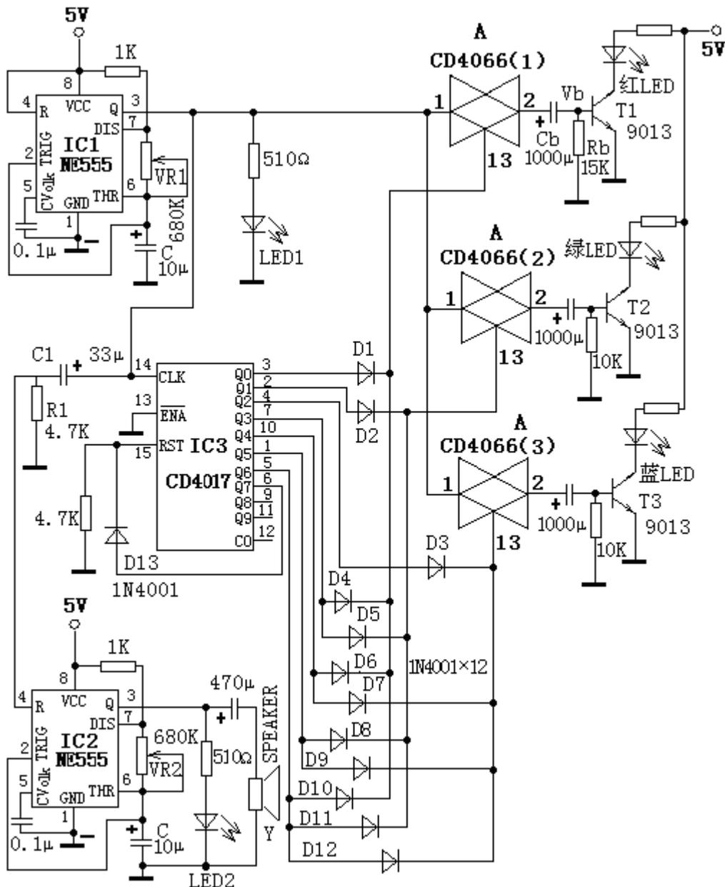
图 40 小型电子声光烟花器电路图
