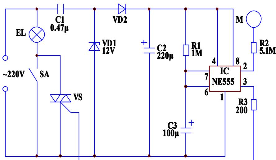
图 23 触摸式延时照明灯电路图
