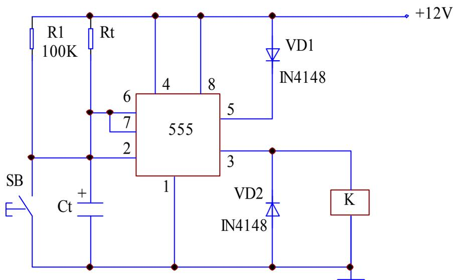
图 11 采用 555 时基电路的简易长延时电路图
