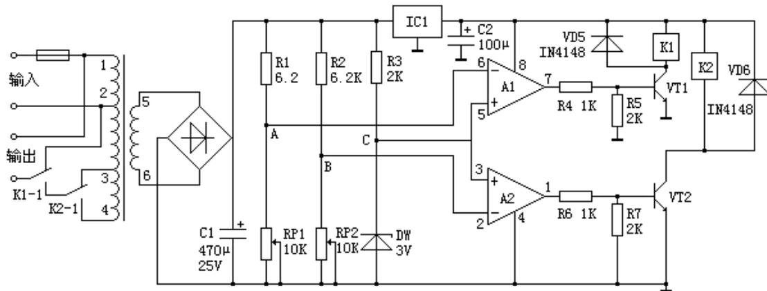
图 43 自制交流自动稳压器电路图
