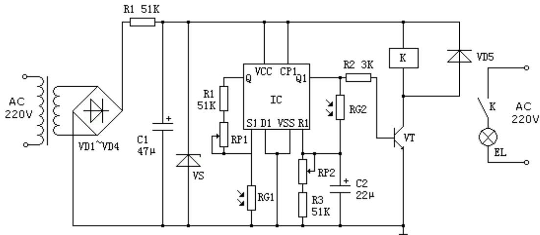
图 20 采用双 D 触发器 CD4013 的路灯控制器电路图
