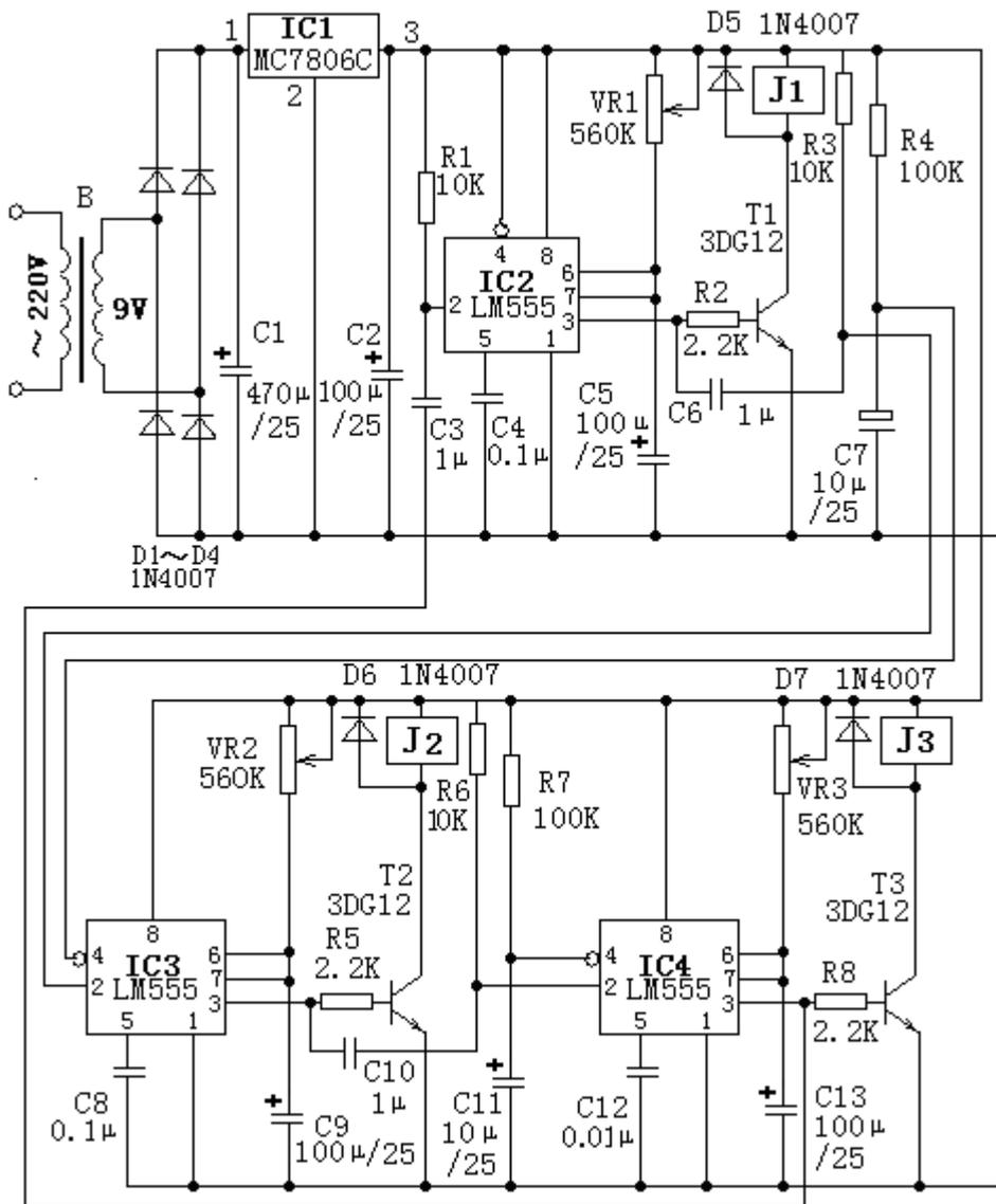
图 16 多级循环定时控制器电路图
