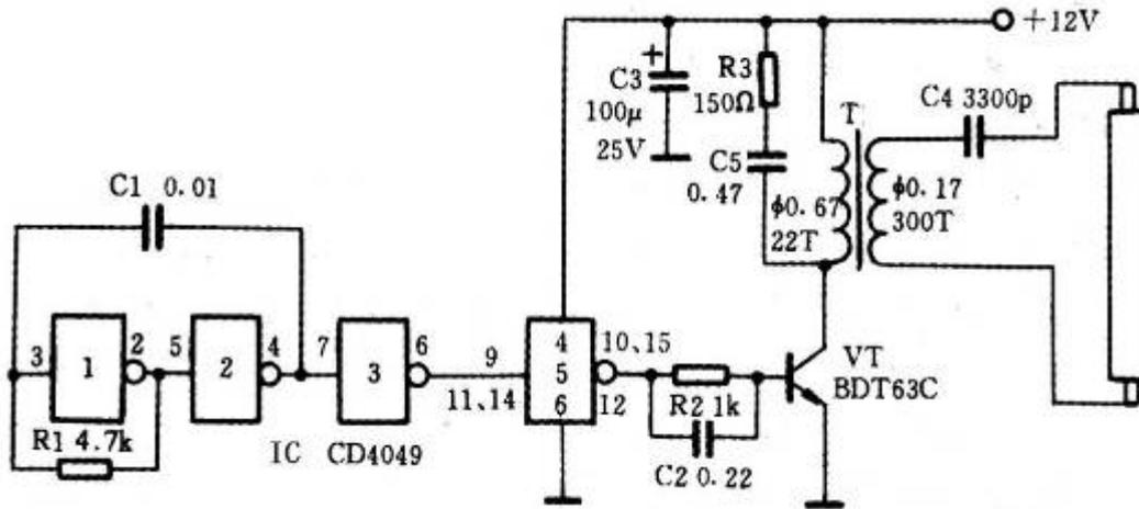
图 26 12V 供电电子节能灯电路原理图
