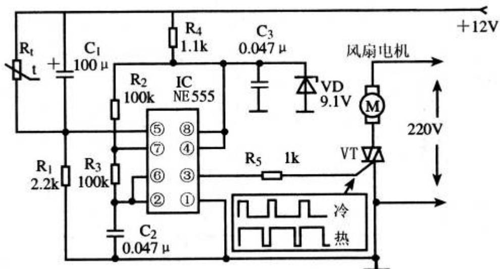
图 37 电风扇自动温控调速器电路原理图
