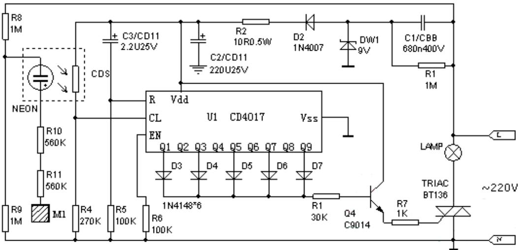
图 21 使用氖灯的单键触摸开关电路图
