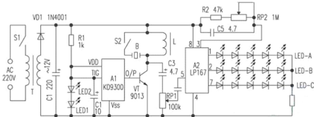
图 39 新颖的鱼缸灯电路图
