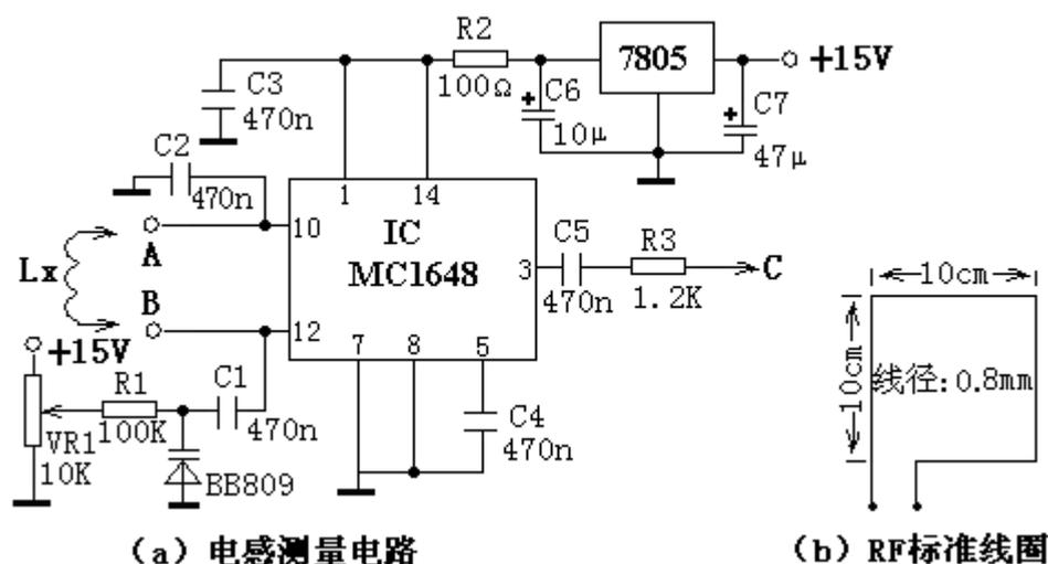
图 1 简单电感测量装置电路图
