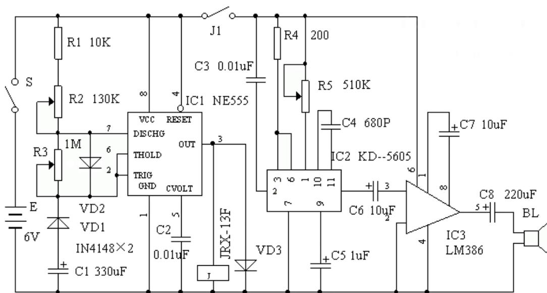
图 28 电子仿声驱鼠器电路图
