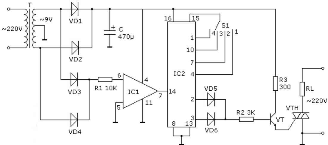
图 50 电气设备调温、调速器电路图
