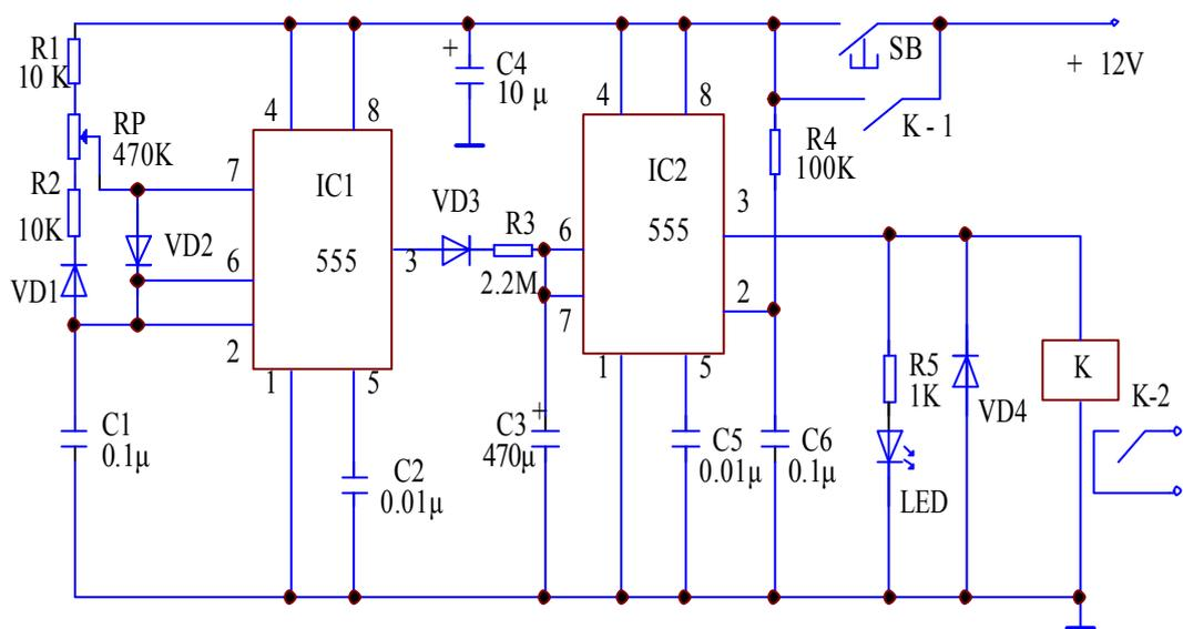
图 12 双 555 时基电路长延时电路图
