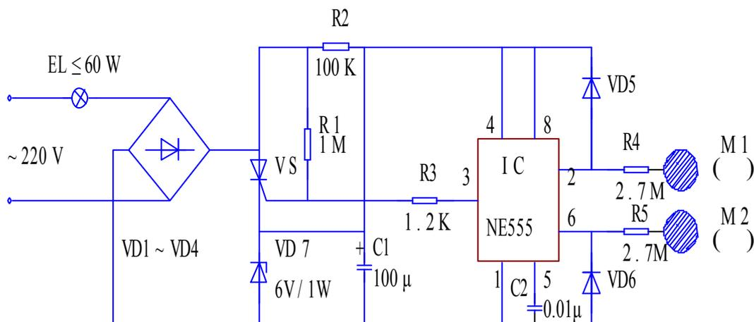
图 22 双键触摸式照明灯电路图
