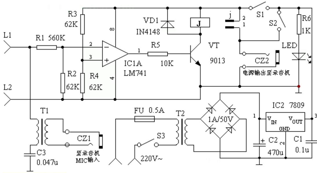
图 36 电话自动录音控制器电路图
