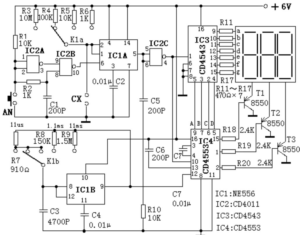
图 2 三位数字显示电容测试表电路图
