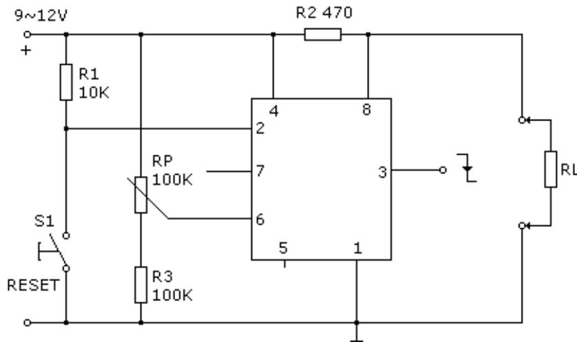
图 42 采用 555 时基电路的过流检测器电路图
