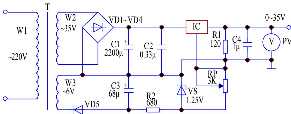
图 46 可调直流稳压电源电路图
