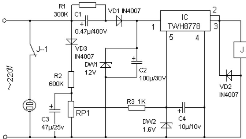
图 35 家用电器过压自动断电装置电路图
