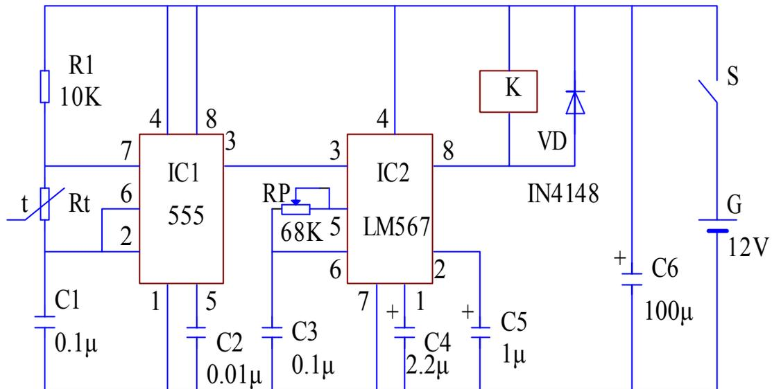
图 7 采用 555 时基电路的自动温度控制器电路图
