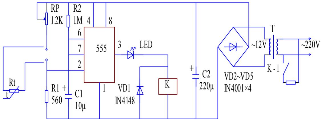
图 10 热带鱼缸水温自动控制器电路图
