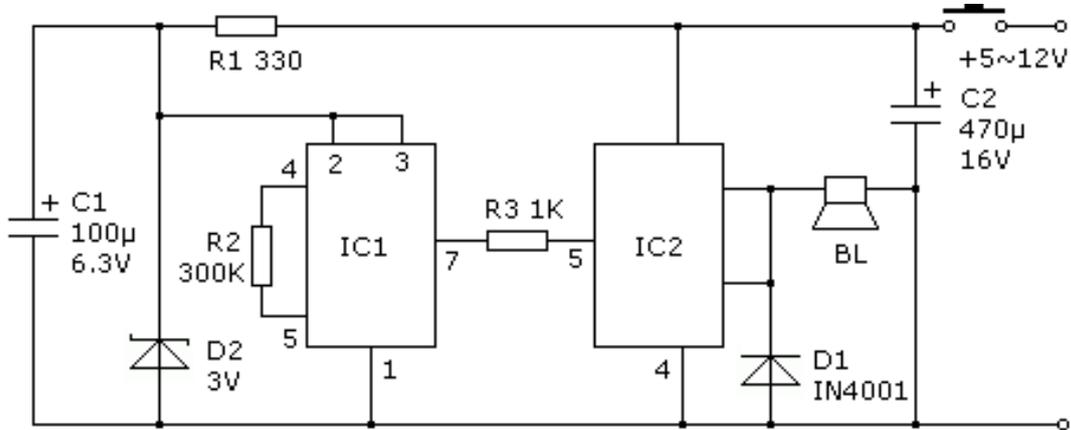
图 27 高响度警音发生器电路图
